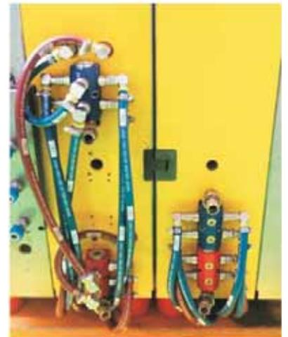
Uzun yıllardır kullanılan eski kalıpları günümüz hızlı bağlantı elemanları ile soğutma sistemlerinin revize edilmesi sonucu verimliliğin artması..
