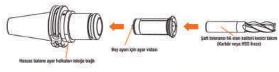
Değiştirilebilir PGR Sıkma pensu için aygırlanmış takım ile de kullanılabilir
